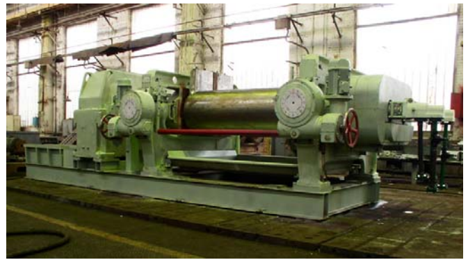
Змішувально-підігрівальні вальці для пластмас ВП-См-Пд 2100(660/660) з потужністю приводного двигуна 200 кВт на складальній дільниці механоскладального цеху № 1 ПАТ «НВП „Більшовик”» (фото автора статті)
