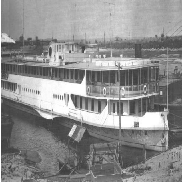
Рис. 5. Пасажирський пароплав проекту СБ 50 (1938 р)
