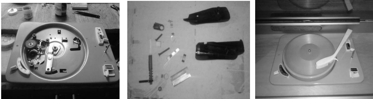
Рис. 5. Почищений та змащений механізм обертання диску ЕПП, чистка головки звукознімача та відремонтований ЕПП у корпусі радіоли
