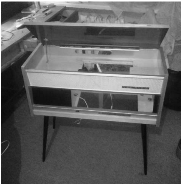
Рис. 2. У процесі збирання корпусу після чищення та полірування. Встановлено ніжки, які були відсутні раніше
