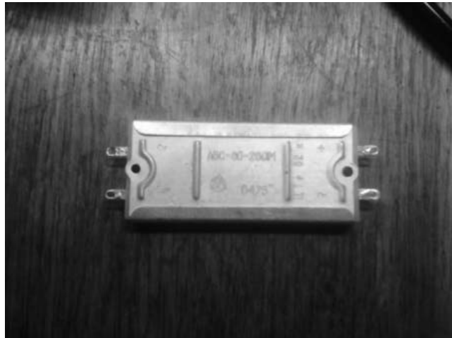
Рис. 6. Заміна селенових елементів на напівпровідникові діоди на прикладі селенового випрямляча типу ABC-80-260M
