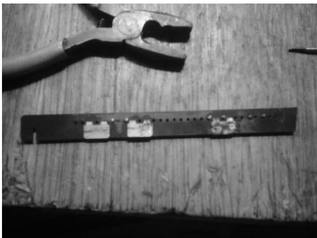
Рис.3. Окислені контакти планки перемикача та повністю почищений та змащений вузол перемикачів діапазонів
