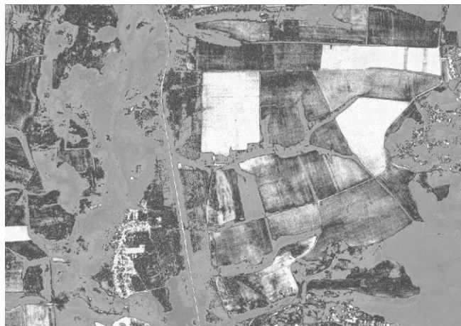
Рис. 1.1 – Приклад застосування індексу NDVI для визначення сільськогосподарських земель у Дергачівському районі Харківської області (RapidEye; 10.06.2009; 50°04'и 35°57')
