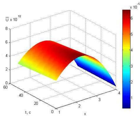
Р и с . 1 . Зависимость безразмерных смещений частиц карста от безразмерной радиальной координаты и времени.
