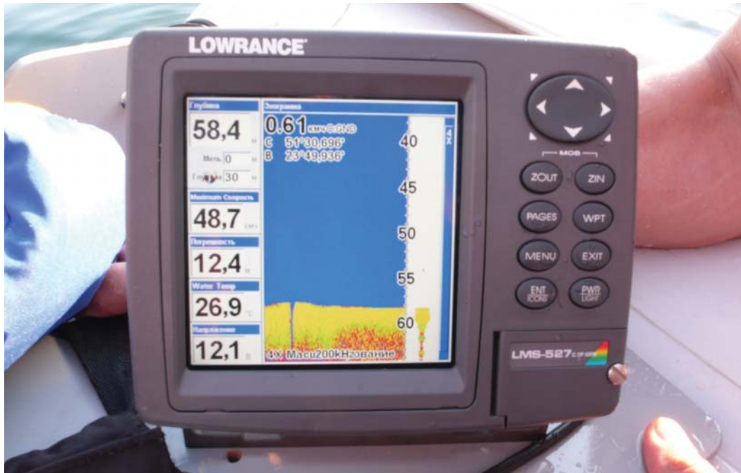
Рис. 5. Результати локації дна озера Світязь. Зафіксовано максимальну глибину 58,4 м.
