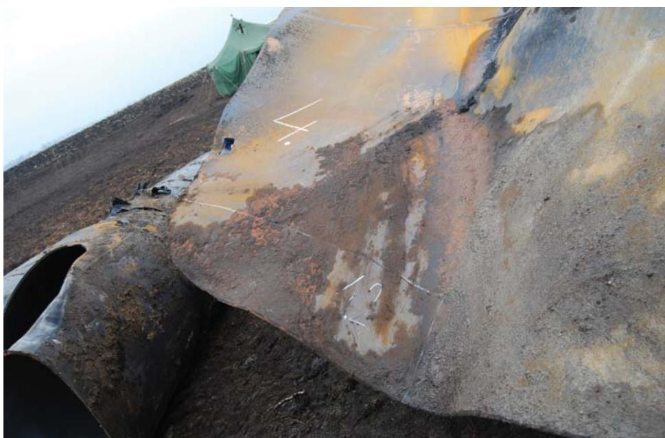
**Рис. 2. Аварія газопроводу у твердому ґрунті**
