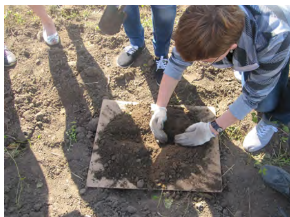
Рис. 14. Відібрані у чотирьох кутах і у центрі «конверта» проби перемішуються, квартуються і таким шляхом формується одна проба
