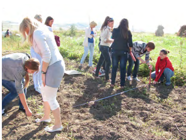
Рис. 11. Розміщення «конверта» у точці відбору проби
