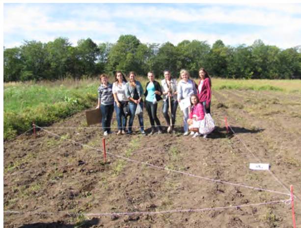
Рис. 10. Відбір проб ґрунтів здійснюється методом «конверта» згідно державного стандарту
