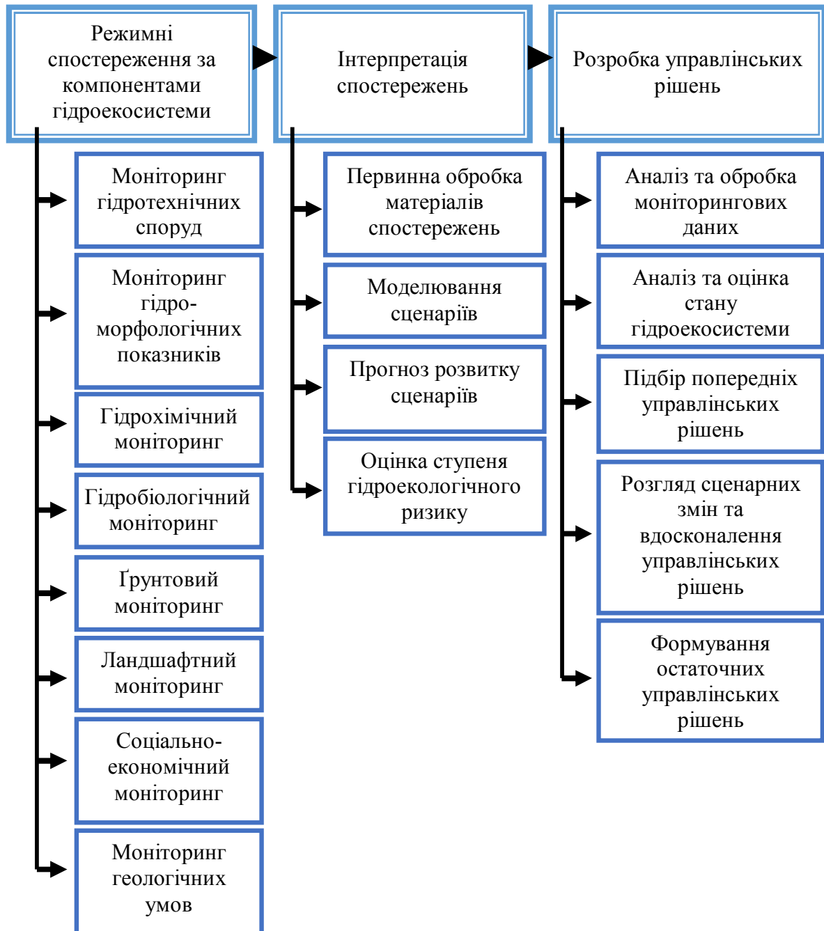
Рис. 1. Функціональна схема організації моніторингу гідроекосистеми
