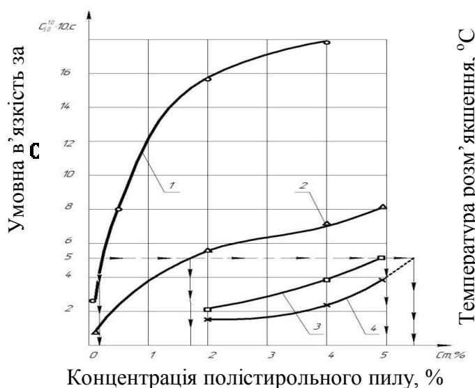
Рис. 4. Діаграма для визначення еквів'язкої концентрації  $C_m$  ПСП у в'яжучому на дьогтях з вихідною в'язкістю: 1 –  $C_{30}^{10}=29$  с; 2 –  $C_{30}^{10}=250$  с; 3 –  $C_{30}^{10}=150$  с; 4 –  $C_{30}^{10}=50$  с
