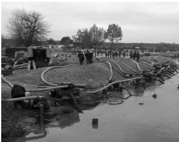
Рис. 2. Гідромеханічний спосіб видобутку бурштину
