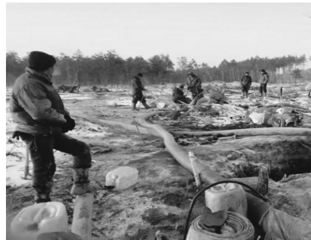
Рис. 2. Гідромеханічний спосіб видобутку бурштину
