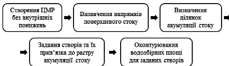
Рис. 1. Алгоритм визначення контурів водозбірних площ території
