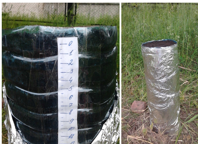
Рис. 1. Модельний дослід вертикальної міграції нафти у ґрунті
