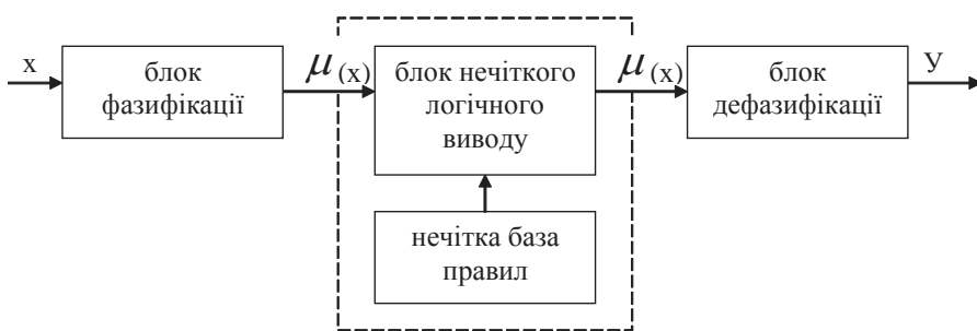
Рис. 2. Типова структура системи прийняття рішень у нечіткій логіці
