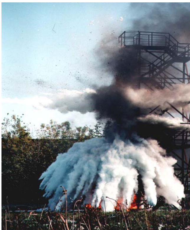
Рис. 2. Подвесная бомба емкостью 250 л, конусообразного распыления различных огнетушащих, локализирующих и защитных составов по площади до 300 кв. м.
