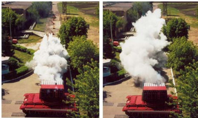
Рис.1. Многоствольная установка на базе танкового шасси Т-62
