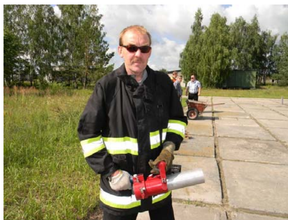
Рис.3. Импульсный универсальный распылитель.
