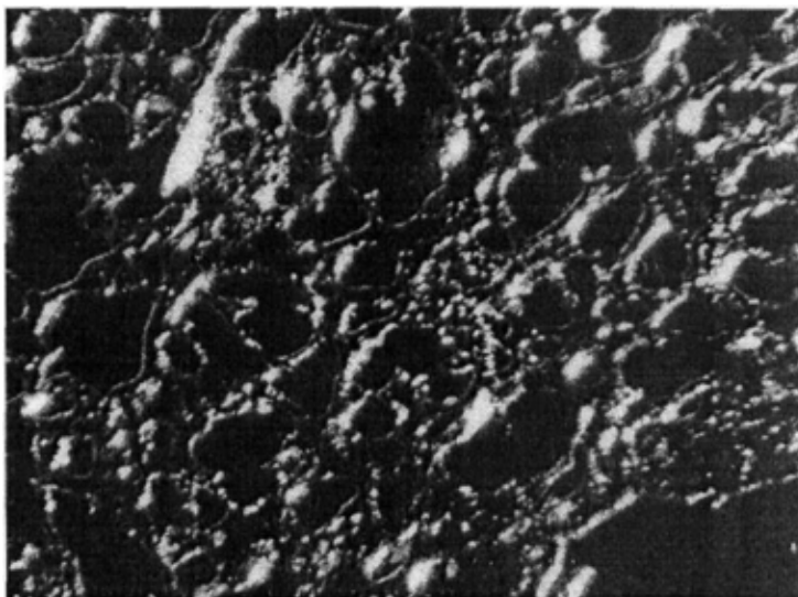
Рис. 5. Фотографія електровибухового руйнування вольфрамової дроту діаметром 14,5 мкм, отриманої з радіаційного технології. Збільшення x150
