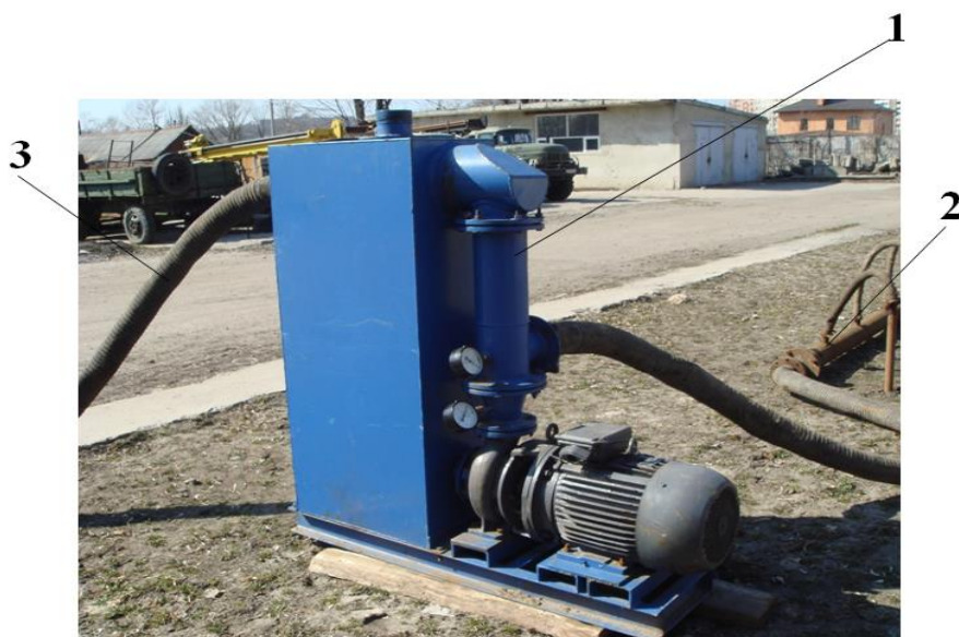
Рис. 1. Общий вид установки ПУВВ-5МЕА: 1 – приводная станция установки; 2 – линейная всасывающая система с иглофильтрами; 3 – сливная линия
