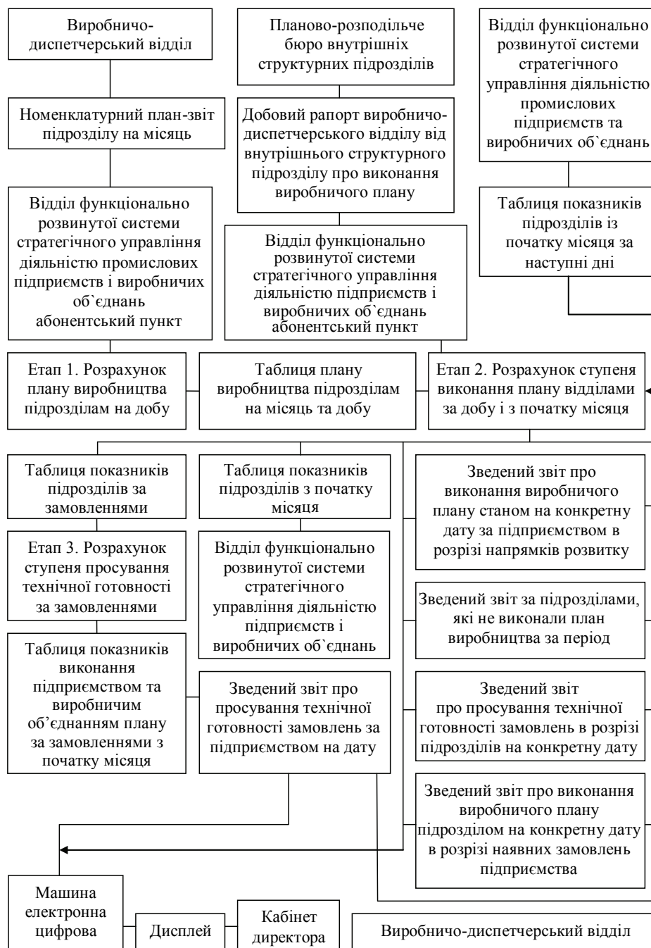
Рис. 1. Укрупнена блок-схема цільової програми функціонально розвинутого вирішення оперативного завдання щоденної діагностики виконання промисловим підприємством (об'єднанням) виробничого плану
