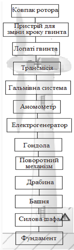
Рис. 3. Складові блоки промислової вітряної установки
