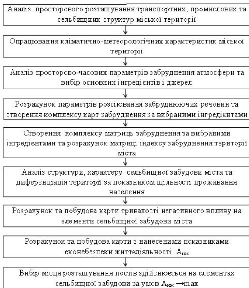
Рисунок 5 – Алгоритм вибору місць розташування постів міської системи екомоніторингу
