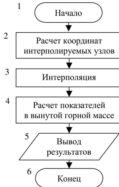
Рис.4. Укрупненная блок-схема алгоритма реализации задачи определения содержания показателей в вынутой горной массе
