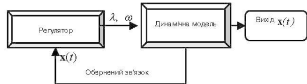
Рис. 1. Схема оберненого зв'язку в системі
