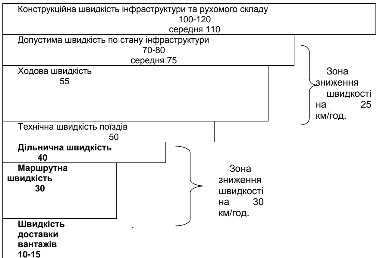
Рис. 2. Діапазон швидкостей залізничного транспорту
