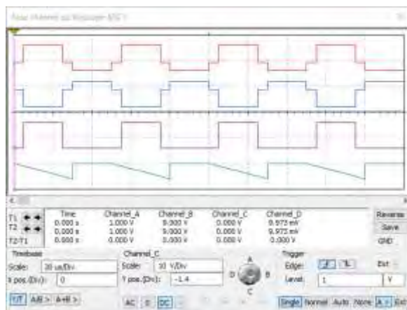
Рисунок 8 – Осциллограммы сигналов на входе/выходе трансформатора, входе управления ключа S2 и на выходе выпрямителя (нижняя) для схемы, приведенной на рис. 7
