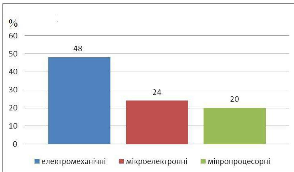
Рисунок 3 – Ілюстрація розподілу випадків хибної (надлишкової) дії пристроїв ДЗТ в залежності від елементної бази
