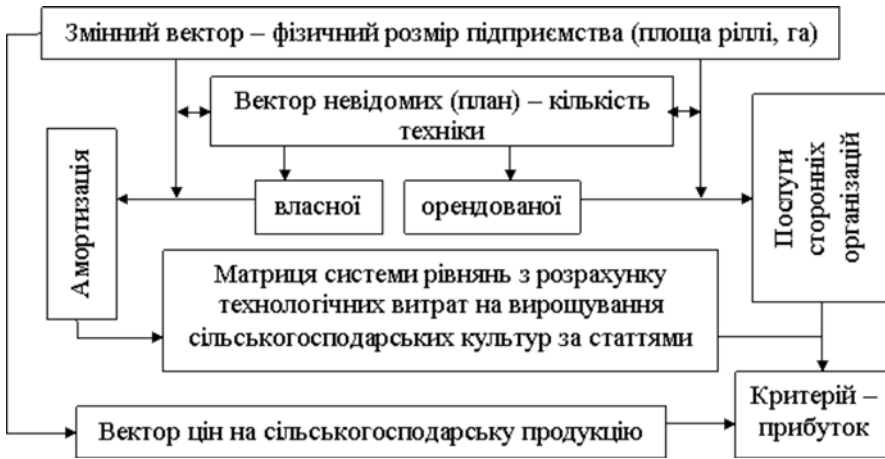
Рис. 1. Структурна схема моделі оптимізації потреби в техніці фермерських господарств з урахуванням її оренди
