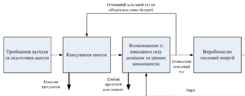
Рис. 2. Укрупнена схема матеріальних потоків КХП
