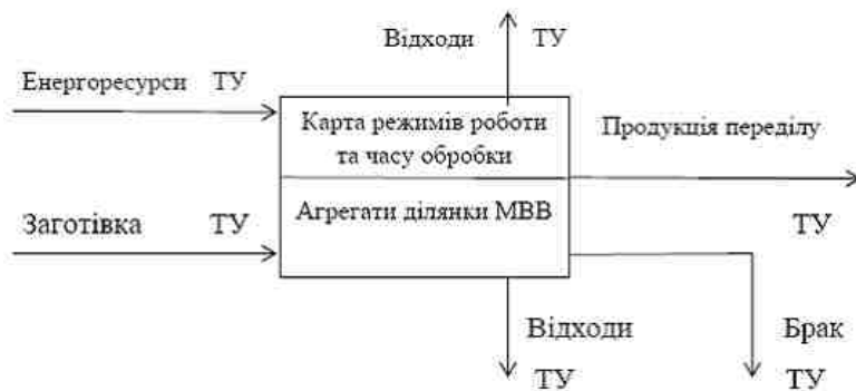
Рисунок 2. Укрупнена типова схема ділянки технологічного маршруту у виробничому модулі
