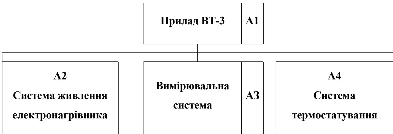
Рис. 1. Структурна схема установки для вимірювання коефіцієнта теплопровідності твердих тіл
