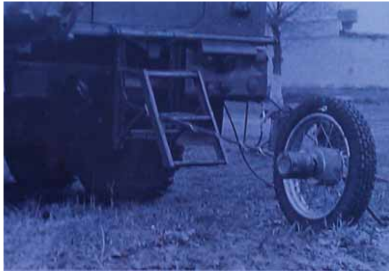
Рис. 2. Использование прибора путь-время-скорость для записи параметров движения автомобиля
