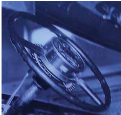
Рис. 5. Динамометрическое рулевое колесо с самописцем записи углов поворота и приложенного усилия, с потенциметрическим датчиком угла поворота
