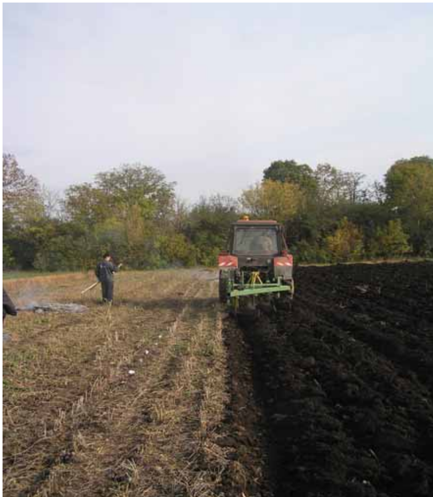
Рис. 1. Плуг з дисковим подрібнювачем в роботі
