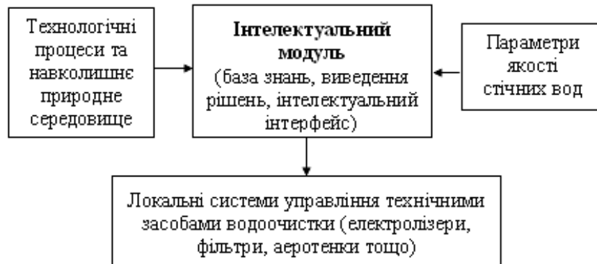
Рис. 2. Архітектура системи управління комплексними методами водоочистки стічними водами промисловими об'єктами (з інтелектуальним модулем)
