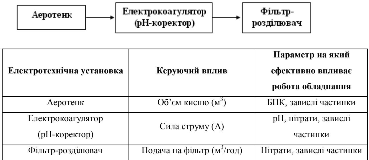
Рис. 3. Структура електротехнічного комплексу очистки стічних свиногокомплексу (укрупнено)
