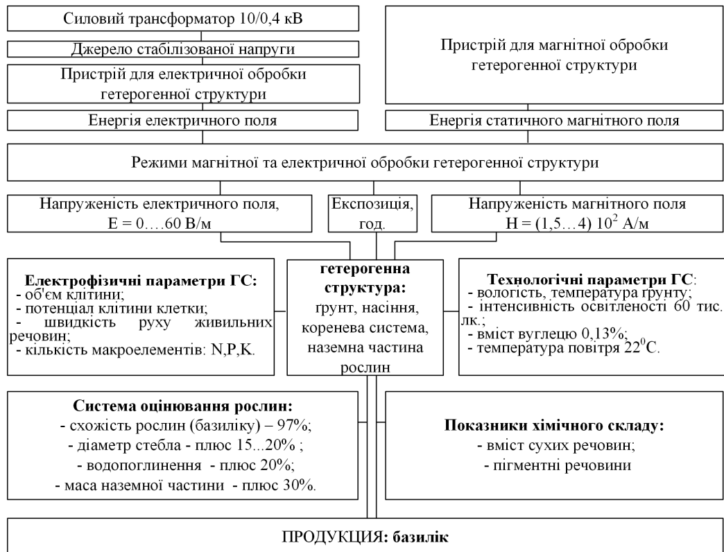
Рис. 2. Функціональна схема електротехнічної та магнітної систем
