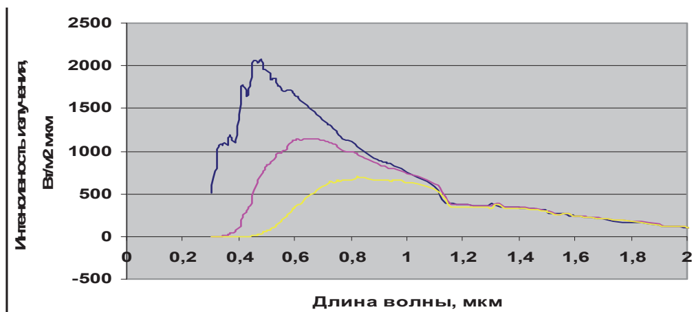
Рис. 4. Характерные расчётные спектры для атмосферных масс AM-9 (средняя кривая) и AM-36 (нижняя кривая) на фоне заатмосферного спектра солнечного излучения AM-0 (верхняя кривая)
