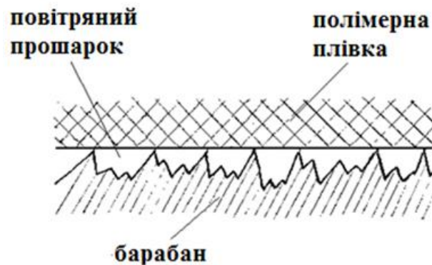
Рис.2 Схема контакту шорсткої поверхні барабана з полімерною плівкою
