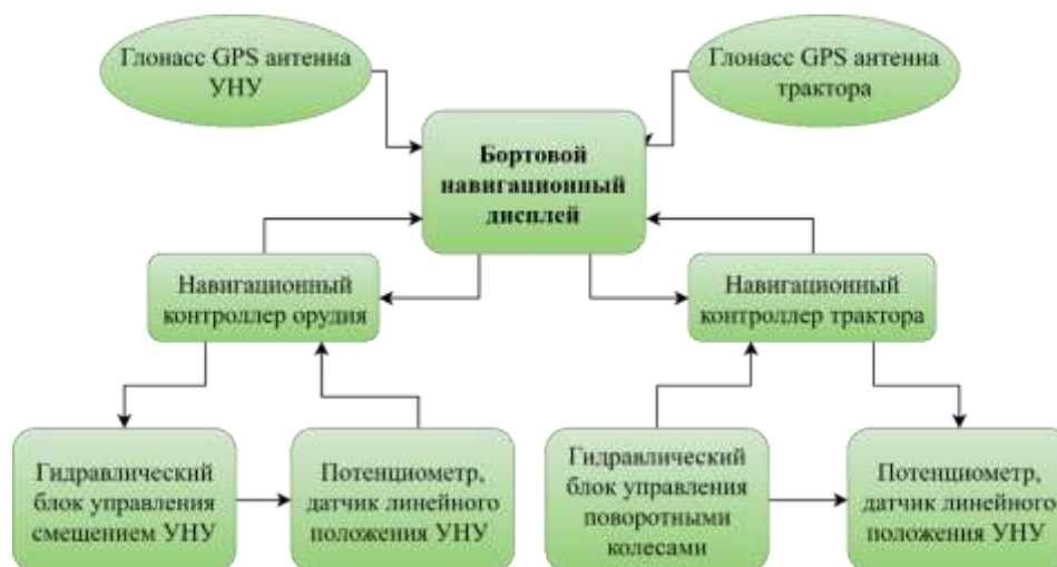
Рис. 3. Схема работы управляемого навесного устройства
