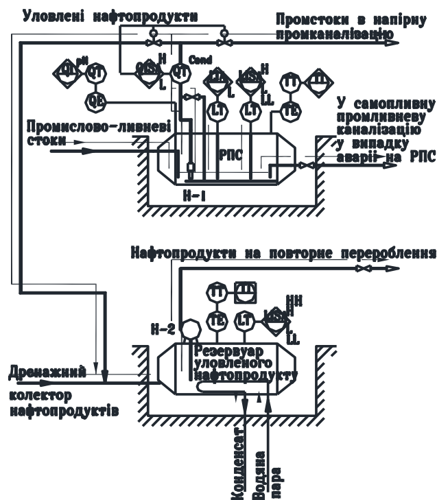
Рис 2. Принципова технологічна схема РПС системи каналізації нафтохімічного підприємства
