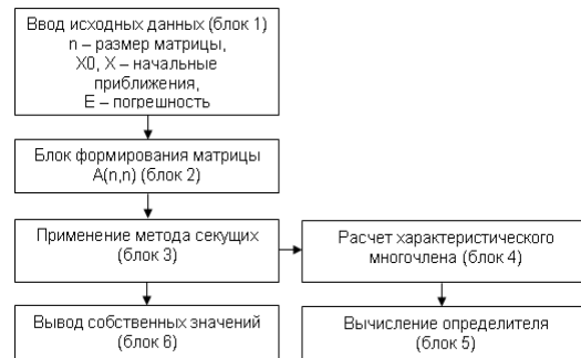
Рис. 2. Алгоритм расчета собственных значений матрицы смежности
