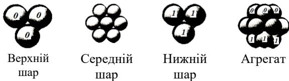
Рисунок 7 – Побудова тришарової моделі з гексагональною ґратки
