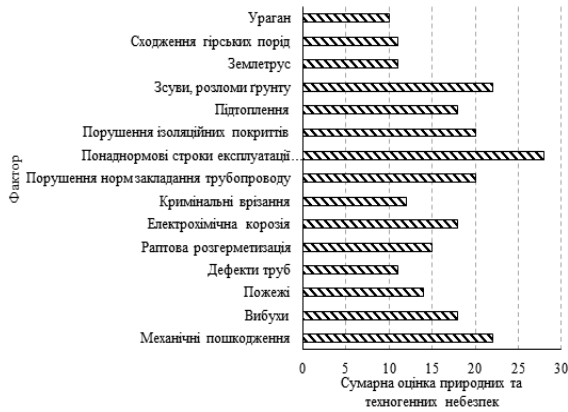
Рисунок 2 – Аналіз природних та техногенних небезпек, що мають місце при експлуатації магістральних трубопроводів
