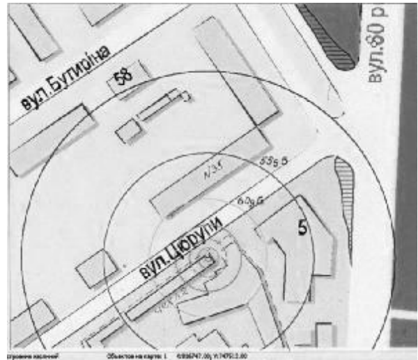
Рисунок 3 – Ситуаційна шумова карта у зоні досліджень при роботі відцентрового вентилятора на Кременчуцькій кондитерській фабриці
