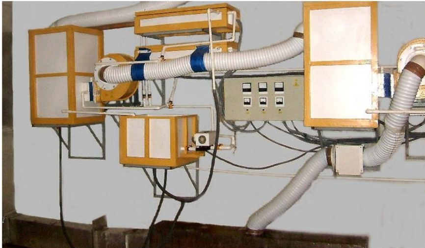
Рисунок 2 – Установа очистки повітря від сірководню абсорбційно-електрохімічним методом
