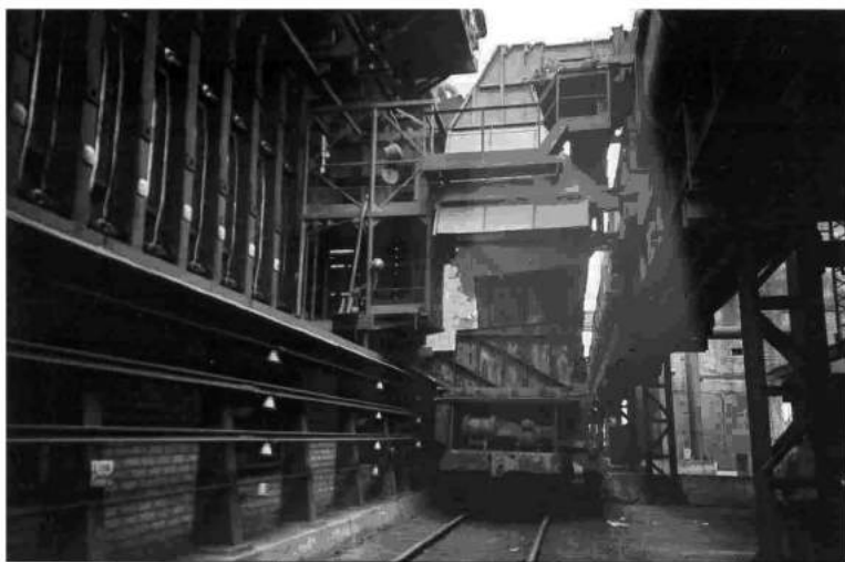
Выдача кокса из печи коксовой батареи № 3 на ОАО «Маркохим» при работе установки БВК
