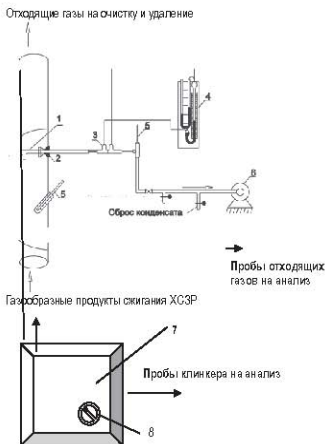
Рисунок 5 – Схема лабораторной установки по определению остаточного содержания токсичных компонентов в твердой и газовой фазах после сжигания хлорсодержащих некондиционных ХСЗР в высокотемпературной муфельной печи:
