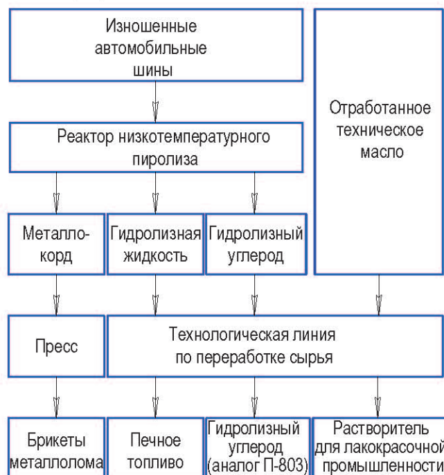
Рисунок 1 – Схема комплекса утилизации изношенных автомобильных шин
