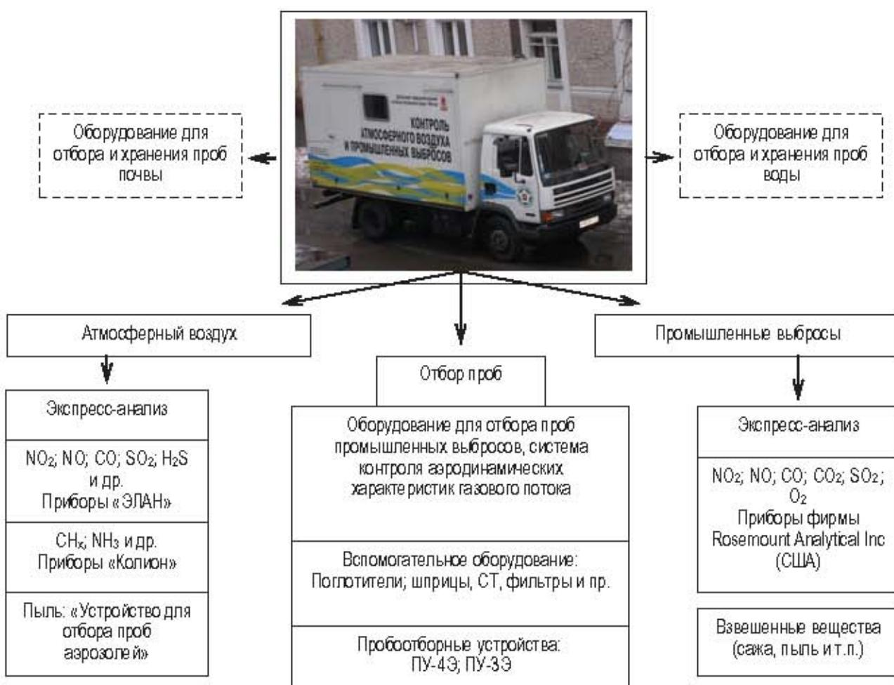
Рисунок 5 – Состав передвижной лаборатории «Кема» для системы оперативного контроля
