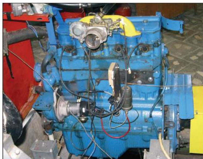
Рисунок 1 – Переобладнаний з дизеля Д-240 газовий двигун на випробувальному стенді
