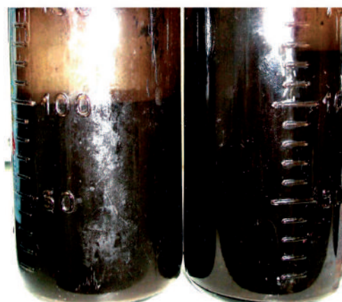
Рисунок 6 – Визуализация осаждения угольных частиц ВУТ, обработанных в кавитаторе в течение 5 минут: слева – на основе чистой воды, справа – на основе фенольной воды
