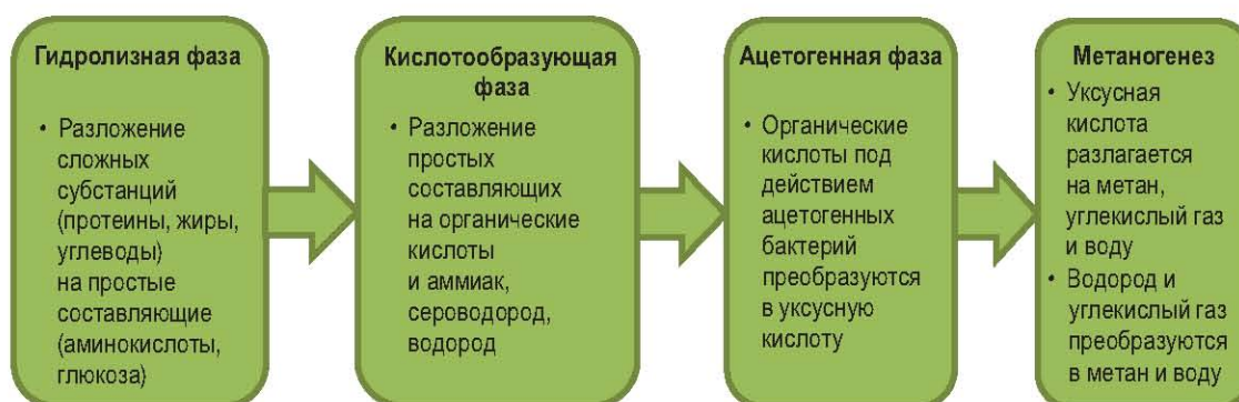
Рисунок 1 – Принципиальная схема процесса образования биогаза
