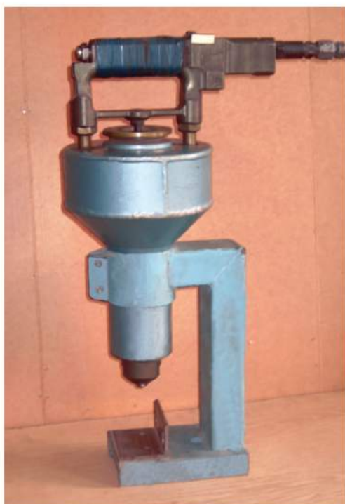
Рисунок 2 – Установка импульсного брикетирования со скоростью исполнительного механизма до 50 м/с.
