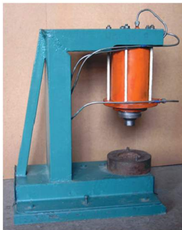
Рисунок 3 – Установка импульсного брикетирования со скоростью исполнительного механизма до 10 м/с.
